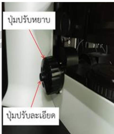
รูปที่ 3.35 แสดงปั๊มปรับสเกลการขยายภาพของเครื่อง Dispersive Raman microscope
